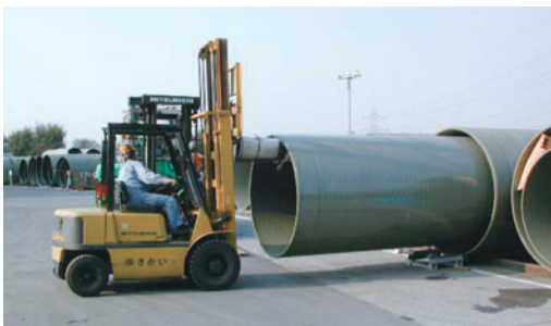
パイプ内にひとまわり小さいパイプを挿入し、運送するネスティングを実施。
