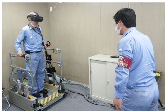
VR(仮想現実)危険体感設備
