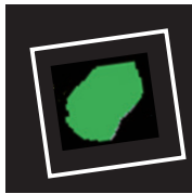
図2 骨材領域に外接する正方形 (疑似ふるい目)
