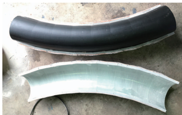
図9 45° 曲率半径1,200 mm 曲管部施工時のライナの外観
