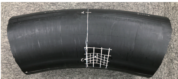
図 10 45° 曲率半径600 mm 曲管施工時のライナ内側の凹み不良
