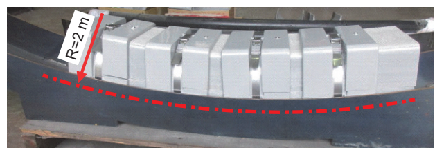
図15 縦断曲線配管状況
