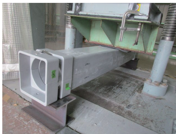
図10 曲げ破壊荷重試験状況
