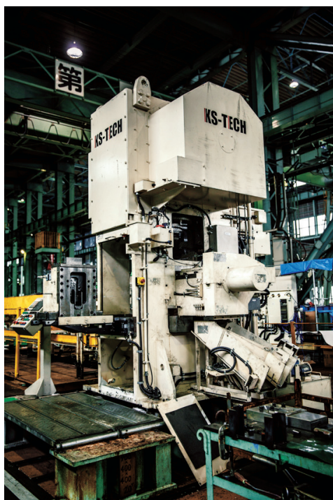
図 2 精密鍛造素材切断機「MACS」
