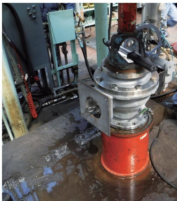
図9 弁座漏れ試験
