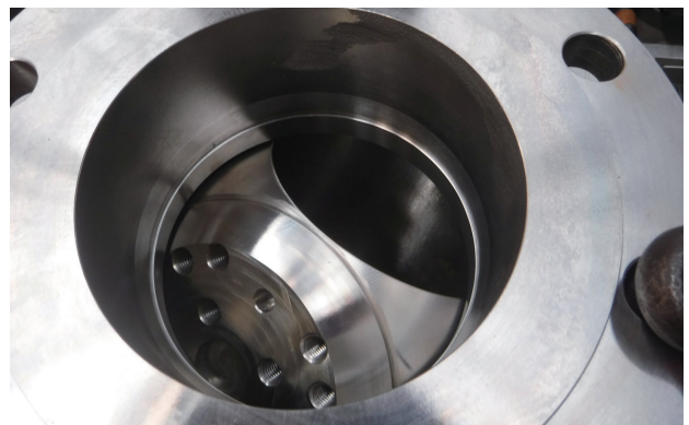
図6 偏心プラグ弁の弁体弁座
