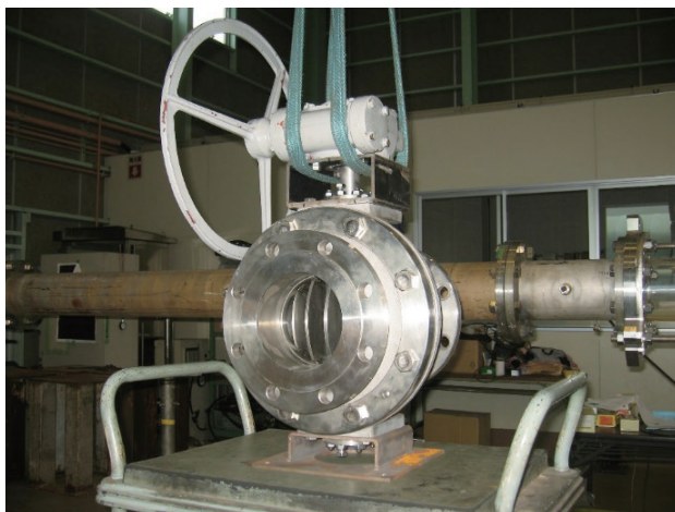
図8 スリットタイプの弁体
