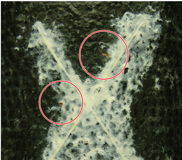
図14 Zn-Al擬合金溶射仕様64日目発錆部
