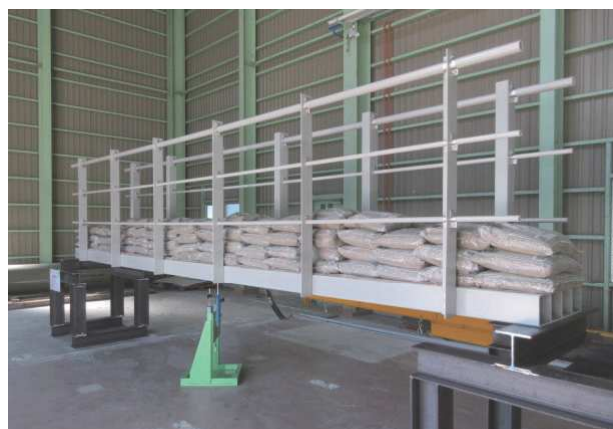
図6 検査路本体の静的載荷試験状況
