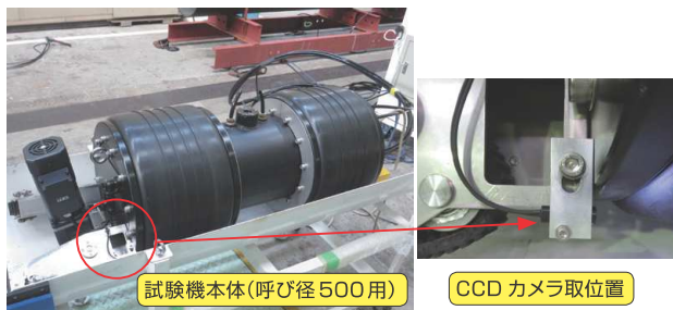
図 18 止水部確認用カメラ設置状況
