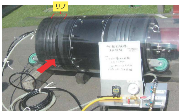
図6 止水性確認試験状況
