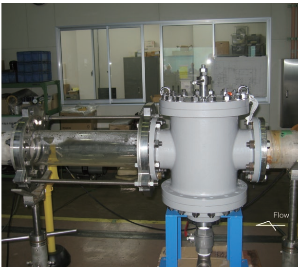
図7 損失係数の確認試験状況
