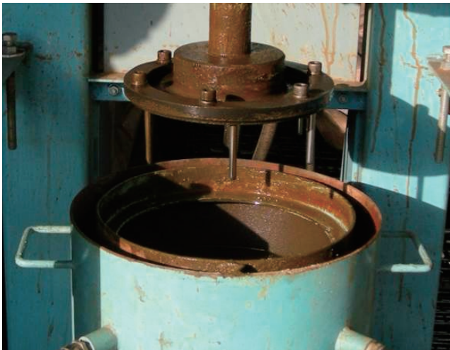
図10 スラリー摩耗試験状況
