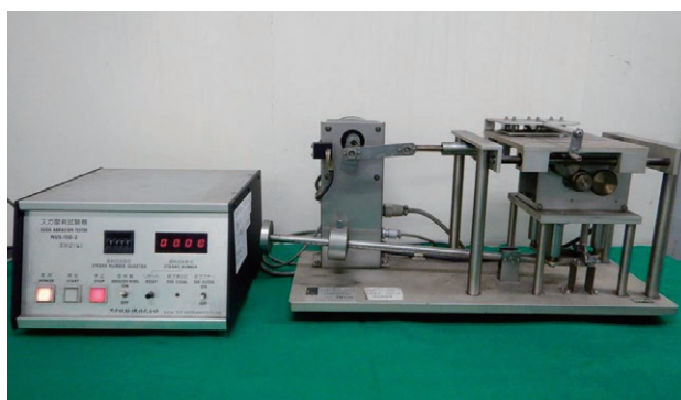
図7 往復運動摩耗試験
