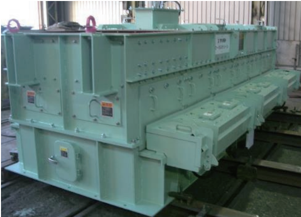
図3 ローラスクリーン 実機の写真 (ローラ幅：1,200mm 処理能力：600t/h)
