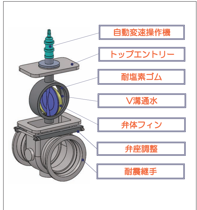
図10 トップエントリー形バタフライ弁
