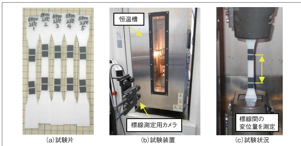
図4 引張弾性率 測定試験状況
