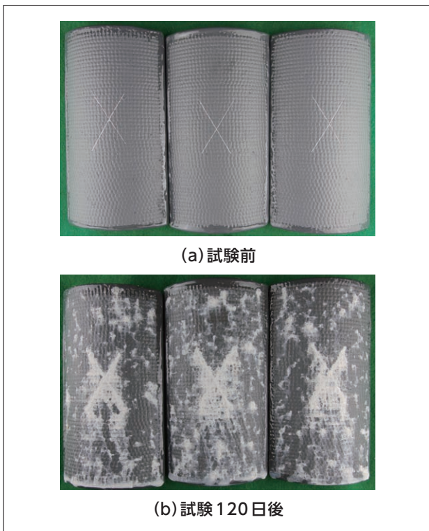
図9 Zn-AlSi擬合金溶射管の複合サイクル試験
