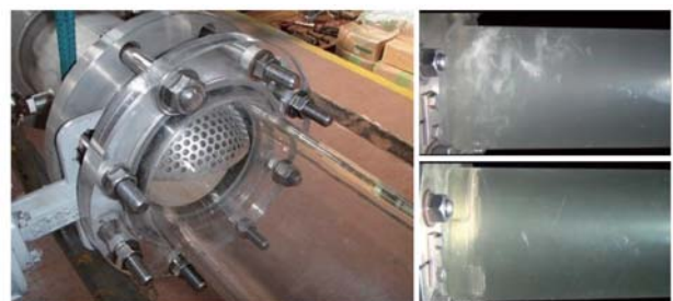
図5 キャビテーション目視試験 ( \sigma \approx 0.3 )
