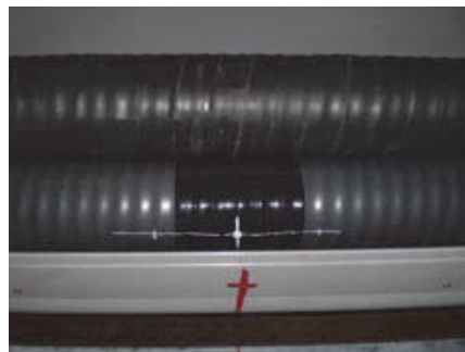
図11 地絡点（試験前）
