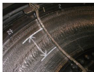
摩耗した肉盛テーブルに KSW 特殊硬化肉盛溶接施工 (現地施工)
