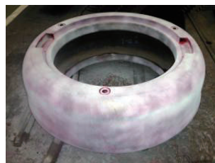
摩耗した高 Cr 鋳鉄ローラに KSW 特殊硬化肉盛溶接施工 (引取施工)
