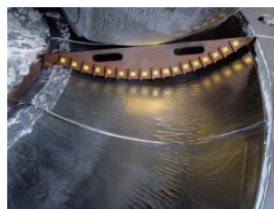
摩耗した高 Cr 鋳鉄テーブルに KSW 特殊硬化肉盛溶接施工 (現地施工)
