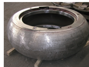
摩耗した高 Cr 鋳鉄ローラに KSW 特殊硬化肉盛溶接施工 (引取施工)
