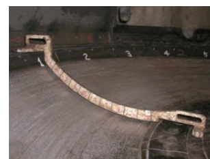
摩耗した肉盛テーブルに KSW 特殊硬化肉盛溶接施工 (現地施工)
