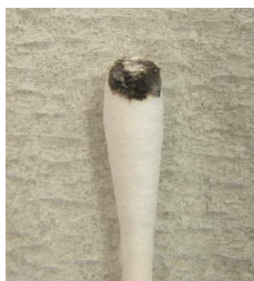
(4週間塩素水に浸漬した従来品の綿棒による評価はレベル5)
