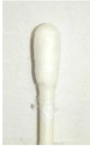
評価レベル2の判定。 図11 開発品の綿棒試験結果
