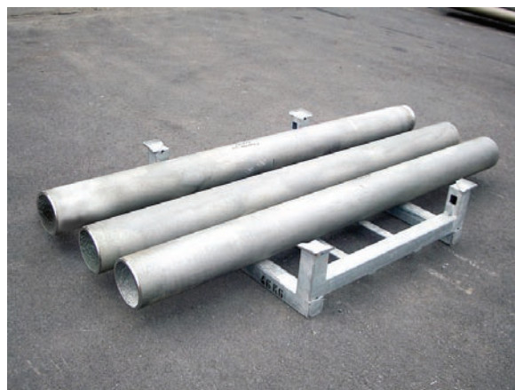
図2 鑄造合金MK-N11を使用した製品一例 ごみ焼却炉用の高温領域熱回収部品(外観) φ200 × L2000 × t12(mm)
