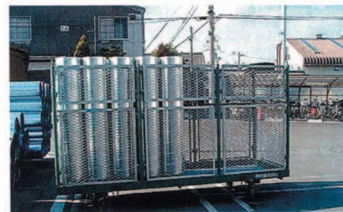
(b) スライドスパイラルの積載状況
