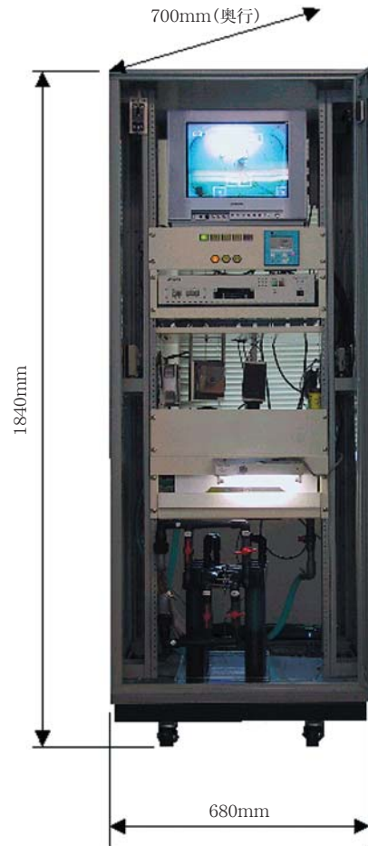
図2 システム本体の外観、主要寸法
